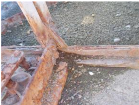
Pohled na skládku hradidel DPH - Koroze dna plováků DPH
